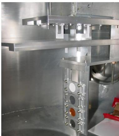
FIGURE 2.9 – Photographie des cibles solides dans le Hall A.
