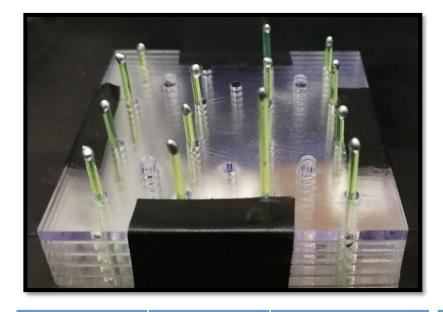
TiO<sub>2</sub> + Epoxy Resin 6 scintillator
