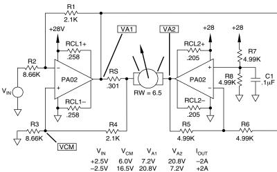
FIGURE 8. LIMITED ANGLE TORQUE CONTROL (SINGLE SUPPLY)
