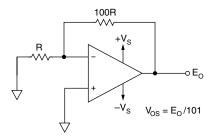
FIGURE 3. INPUT OFFSET VOLTAGE
