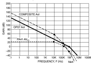
FIGURE 36. COMPOSITE AMPLIFIER AoI MAGNITUDE PLOT
