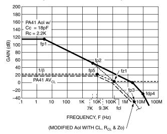
FIGURE 34. POWER OP AMP MAGNITUDE PLOT FOR STABILITY
