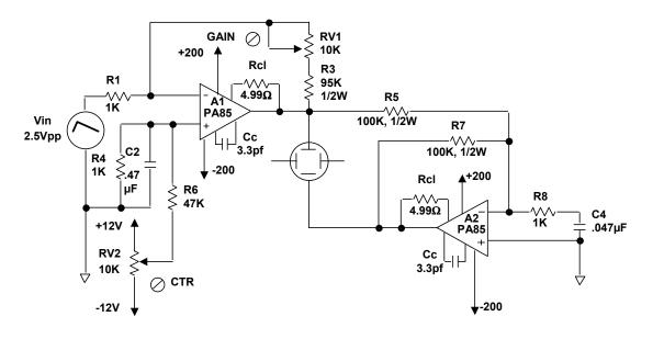
**BALANCED TO MINIMIZE CRT DISTORTION**
