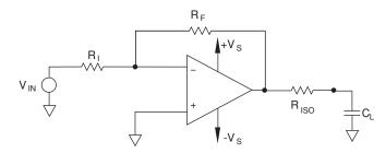
FIGURE 23. CAPACITIVE LOAD ISOLATION
