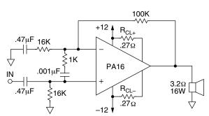
LOW INTERNAL LOSS MAXIMIZES EFFICIENCY
