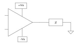
FIGURE 2. THE CLASSIC DUAL SYMMETRIC SUPPLY OP AMP DRIVING A GROUNDED LOAD
