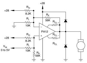
FIGURE 7. UNIPOLAR MOTOR DRIVE EXAMPLE
