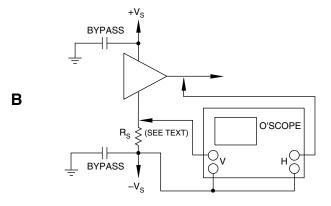
FIGURE 7. OSCILLOSCOPE TESTING OF SOA
