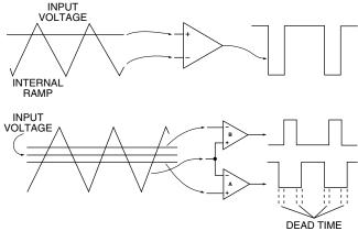
FIGURE 7. PWM WAVEFORMS.
