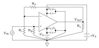
FIGURE 21. BASIC REQUIREMENTS FOR STABILITY
