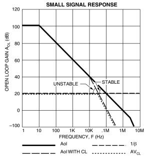
FIGURE 24. CAPACITIVE LOADING
