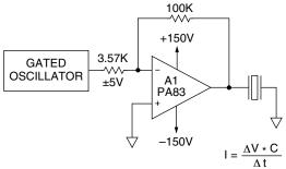
SIMPLE PIEZO ELECTRIC TRANSDUCER DRIVE
