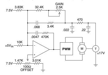
FIGURE 8. PWM SPEED CONTROL.
