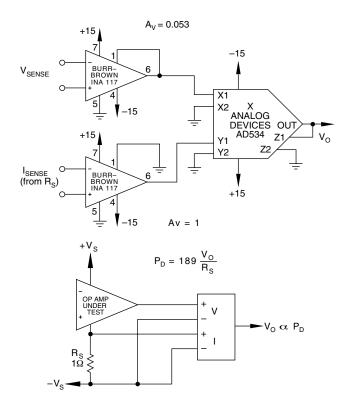
FIGURE 8. INSTANTANEOUS POWER DISSIPATION TESTER
