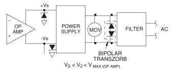
FIGURE 2. OVERVOLTAGE PROTECTION
