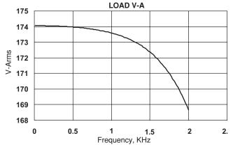
FIGURE 22. POWER DELIVERY TO THE SHAKER TABLE
