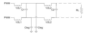
FIGURE 10. GROUND LEG CAPACITORS FILTER HIGH FREQUENCY COMMON MODE NOISE
