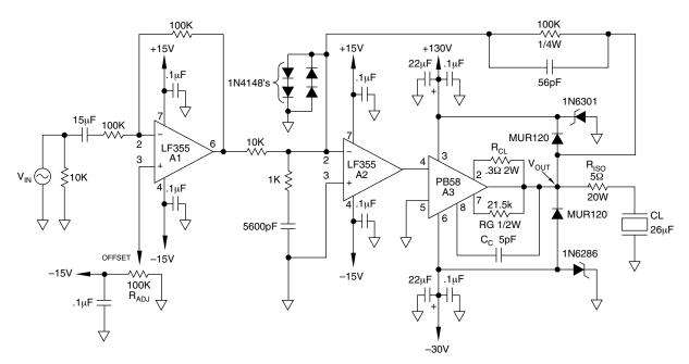
FIGURE 16. PB58 PIEZO DRIVE  $\rm w/R_{\rm ISO}$
