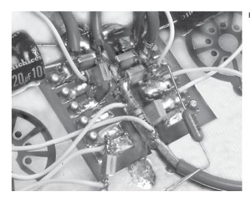
FIGURE 4. SOCKET DETAIL SHOWS THE CENTER OF THE STAR GROUND SYSTEM IS RIGHT IN THE CENTER OF THE SOCKET.
