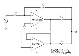
FIGURE 7. PARALLEL OPERATION
