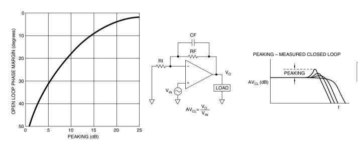
FIGURE 39.  $\mathrm{AV}_{\mathrm{CL}}$  PEAKING TEST
