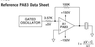
SIMPLE PIEZO ELECTRIC TRANSDUCER DRIVE
