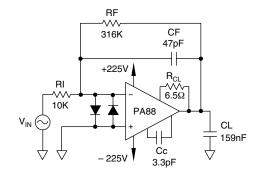
FIGURE 26. FEEDBACK ZERO COMPENSATION FOR CL
