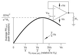
FIGURE 9. AC POWER DISSIPATION VS. PEAK OUTPUT VOLTAGE
