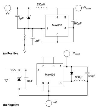
FIGURE 4. VOLTAGE BOOST CIRCUITS
