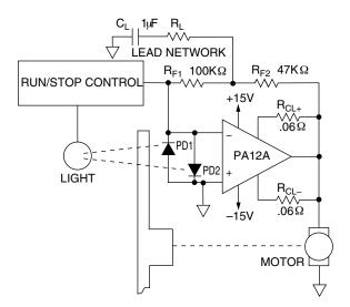
FIGURE 2. SINGLE POINT POSITION CONTROL
