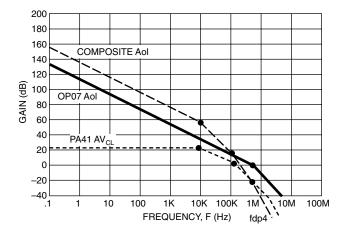
FIGURE 29. COMPOSITE AMPLIFIER AoI MAGNITUDE PLOT
