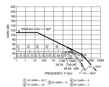
FIGURE 22. A1: MASTER AMPLIFIER MAGNITUDE PLOT FOR STABILITY
