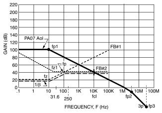
FIGURE 21. FINAL VALUE MAGNITUDE PLOT FOR STABILITY
