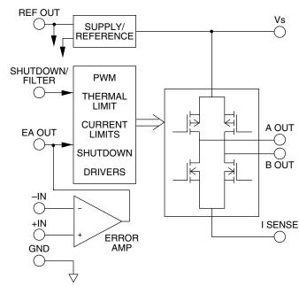
FIGURE 5. SA01 BLOCK DIAGRAM.
