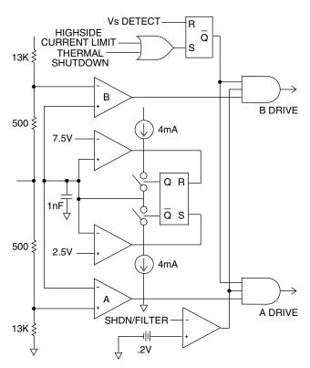
FIGURE 6. PWM CONTROL BLOCK.
