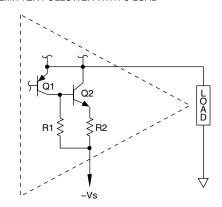
FIGURE 7. COMPOSITE OUTPUT STAGE
