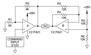
FIGURE 1: BIDIRECTIONAL SPEED CONTROL FROM A SINGLE SUPPLY
