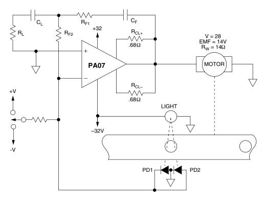
FIGURE 1. SEQUENTIAL POSITION CONTROL
