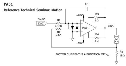
COMPUTER CONTROLLED MOTOR/PROGRAMMABLE TORQUE CIRCUIT
