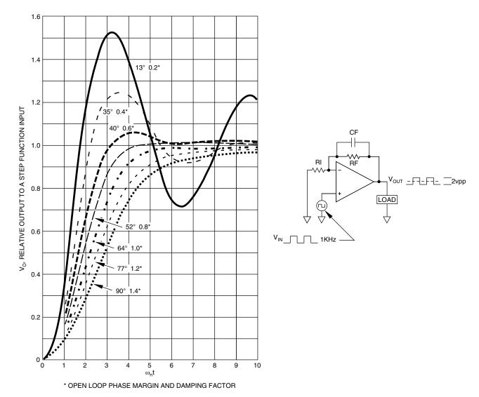
FIGURE 40. SQUARE WAVE TEST
