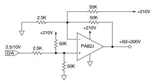
FIGURE 2A. TRUE SINGLE SUPPLY OPERATION
