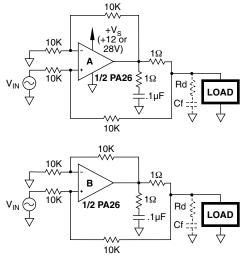
DUAL UNIPOLAR SOLENOID DRIVER 1A/V current output
