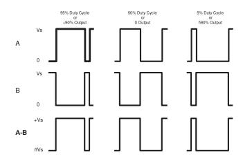
FIGURE 2. H-BRIDGE WAVEFORMS
