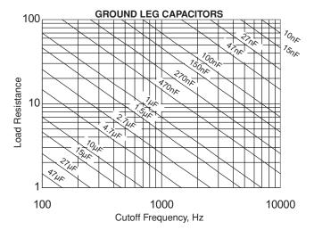
FIGURE 11. GROUND LEG CAPACITORS FOR COMMON MODE FILTERING
