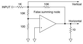
FIGURE 1. SIMPLE TEST CIRCUIT
