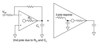
FIGURE 3. CAPACITIVE OP AMP LOADS
