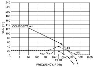
FIGURE 18. COMPOSITE MAGNITUDE PLOT FOR STABILITY
