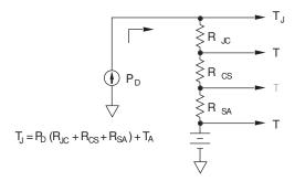
FIGURE 12. SIMPLE THERMO-ELECTRIC MODEL
