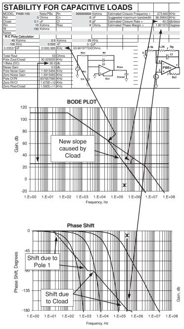
FIGURE 5. MODELING A LARGE CAPACITIVE LOAD
