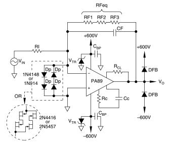
FIGURE 10. HIGH VOLTAGE SUPPORT COMPONENTS
