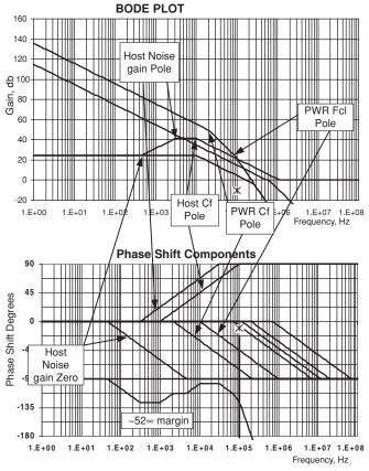
FIGURE 18. THE FINISHED COMPOSITE AMPLIFIER
