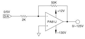
FIGURE 18. NON-SYMMETRICAL SUPPLY OPERATION
