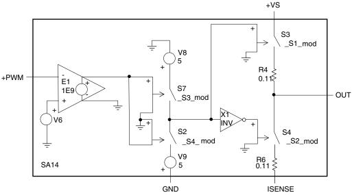
FIGURE 4. SA14 HALF BRIDGE PWM AMPLIFIER SPICE MODEL.
