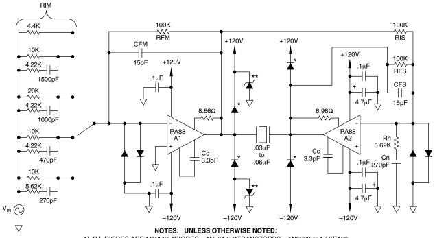
1) ALL DIODES ARE 1N4148; \*DIODES = 1N5617; \*\*TRANSZORBS = 1N6300 or 1.5KE160 2) USE HS02 HEATSINK @ 25°C AMBIENT
