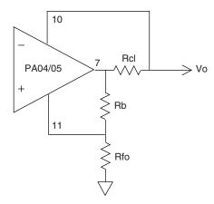
FIGURE 6. FOLDOVER CIRCUIT FOR PA04 OR PA05
