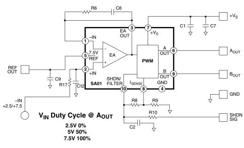
$$(A - B) = \frac{V_{IN} - 5}{2.5} * V_{S} - I_{O} * R_{DSON}$$
