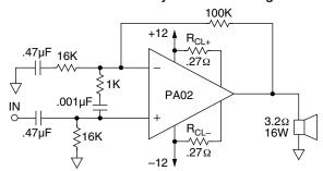
LOW INTERNAL LOSS MAXIMIZES EFFICIENCY
