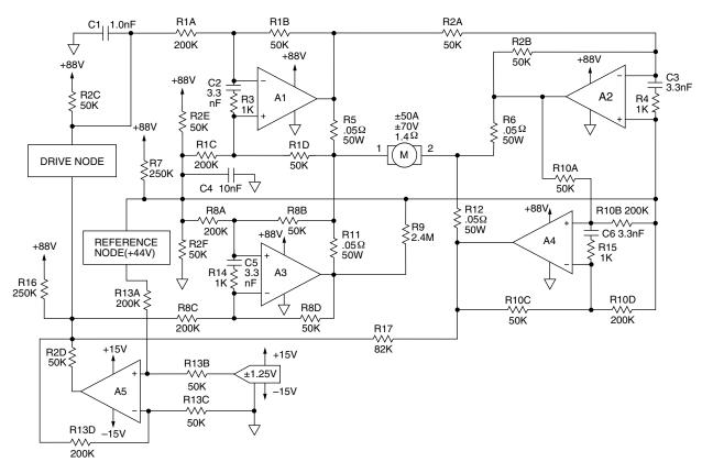
FIGURE 1. APPLYING THE SUPER POWER PA03
