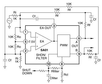
FIGURE 10. VOLTAGE FEEDBACK.
