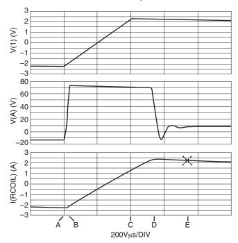
FIGURE 3. RETRACE WAVEFORMS
