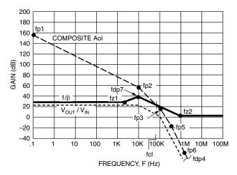
FIGURE 37. COMPOSITE AMPLIFIER MAGNITUDE PLOT FOR STABILITY
