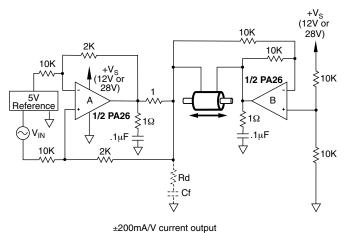
CURRENT CONTROL, SOLENOID OR LINEAR ACTUATOR DRIVE
