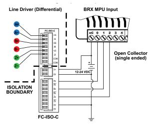
**BRX PLC Wiring Diagram**
