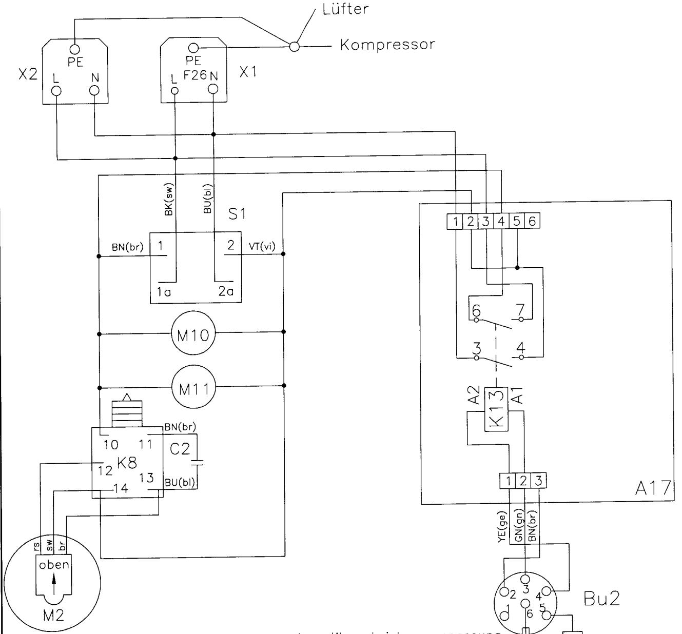
A17 Steuerplatine Kompressorautomatik u Leistungsanpassung
