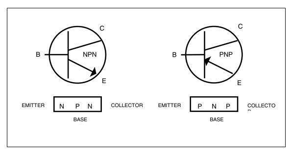
Figure 5-20. Diagram Of An NPN And PNP Bipolar Transistor.
