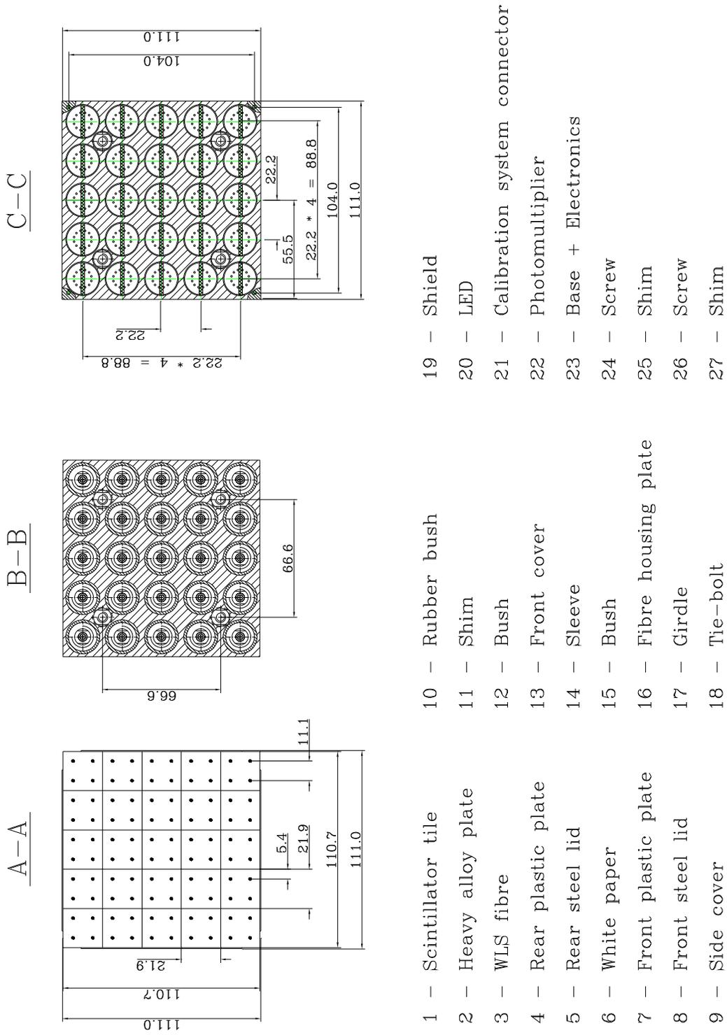
Figure 219: Inner module (Cont. Fig. 218).
